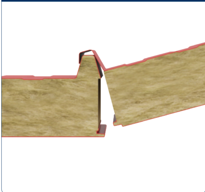
Рис. 7а. Монтаж кровельных панелей
